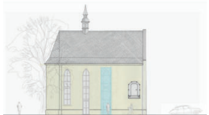
Leonhardskapelle: Geplante Lage des Aufzugs, Hofansicht
