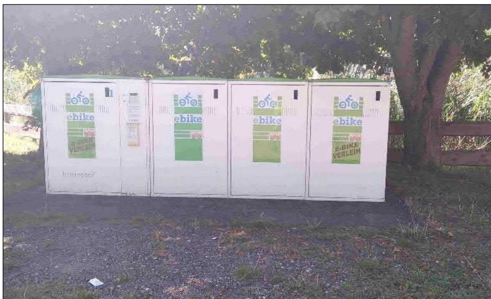
Bild 35: Fahrradboxen mit integrierter Lademöglichkeit für Elektrofahrräder (Quelle: eigene Aufnahme)
