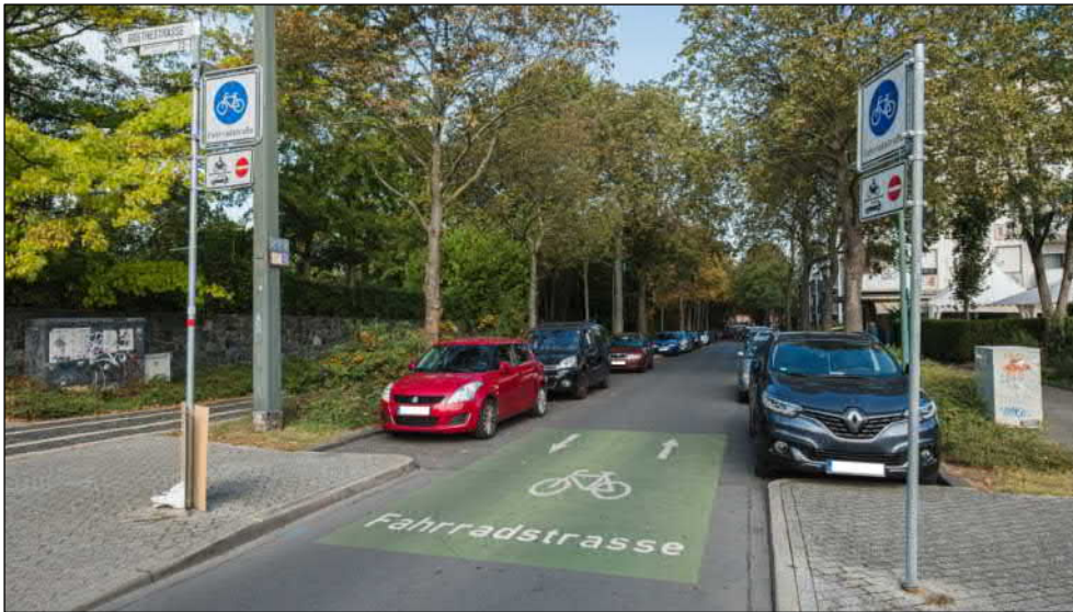
Bild 41: Eingangsbereich einer Fahrradstraße (Quelle: eigene Aufnahme)
