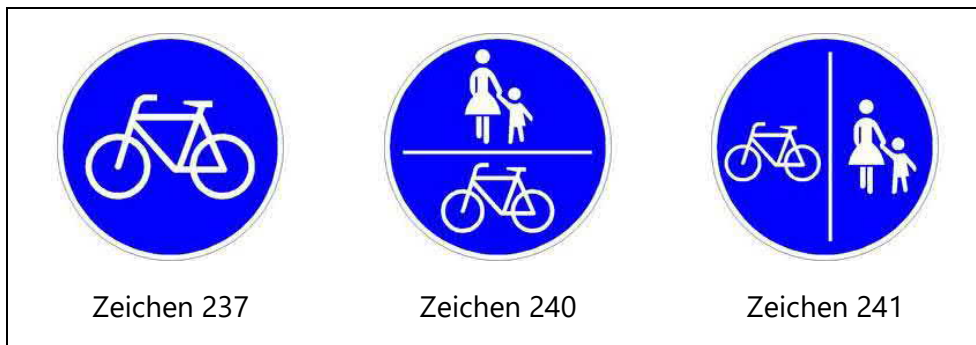
Bild 4: Zeichen für die Benutzungspflicht von Radverkehrsanlagen (Quelle: eigene Darstellung; Grundlage: Bundesministerium der Justiz und für Verbraucherschutz – Bundesamt für Justiz, 2020, StVO Anlage 2 (zu § 41 Absatz 1))
