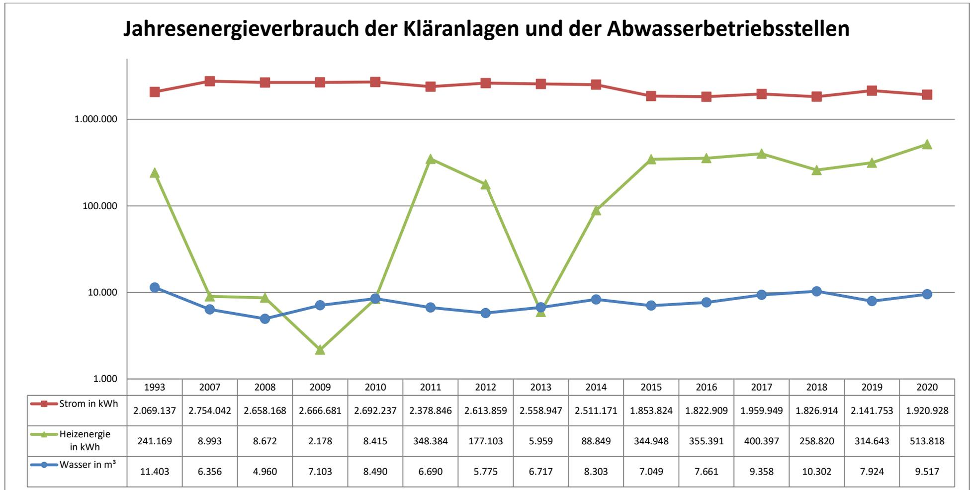
In 2011 wurde eine Micro-Turbine betrieben. Ende 2014 wurde ein mit Faulgas betriebenes BHKW (Blockheizkraftwerk) eingebaut.
