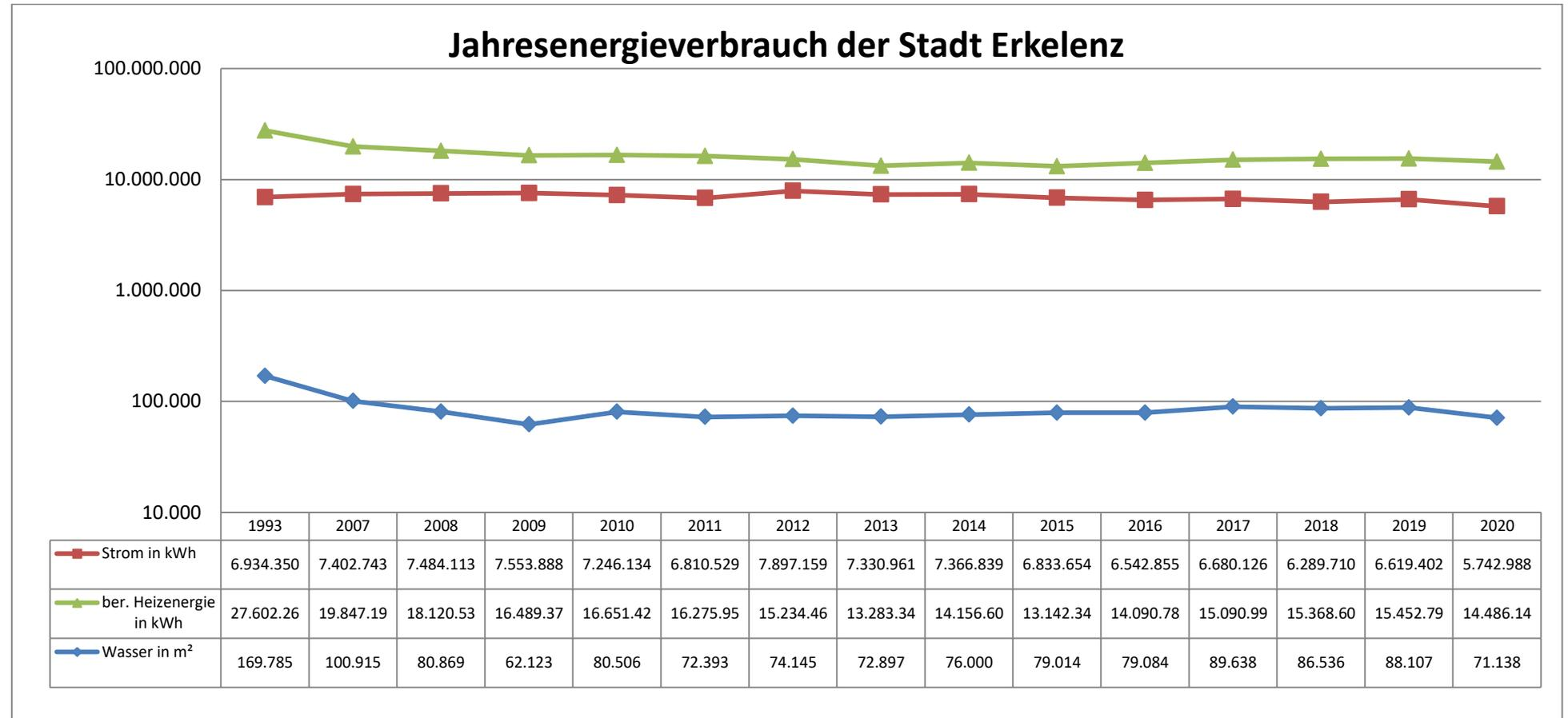
In dem Diagramm sind der Stromverbrauch einschl. Straßenbeleuchtung, der bereinigte Heizenergieverbrauch, sowie der Wasserverbrauch dargestellt.
